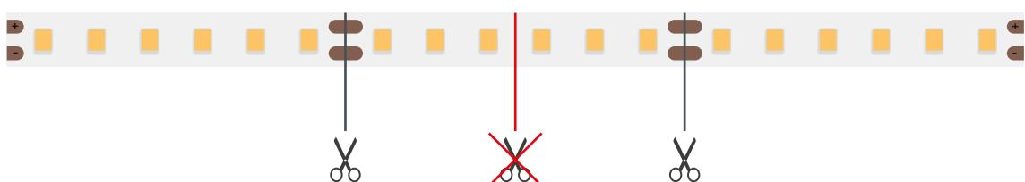
**ВНИМАНИЕ! Резка ленты допускается только в обозначенных местах**
