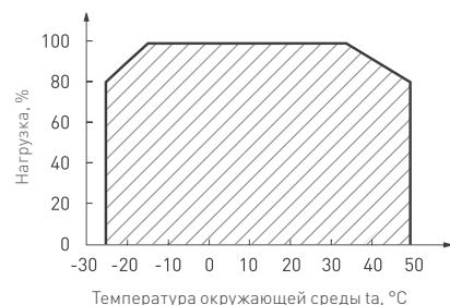
Рис. 2. Максимальная допустимая нагрузка, % от мощности источника
