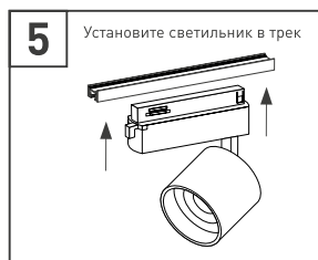
Рис. 2. Установка и подключение светильника
