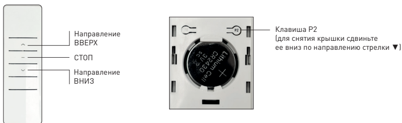
Рис. 7. Пульт управления карнизом для штор
