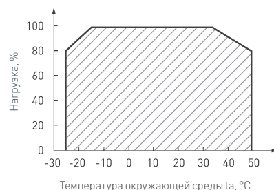
Рис. 2. Максимальная допустимая нагрузка, % от мощности источника
