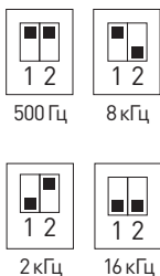
Рис. 3. Установка частоты ШИМ
